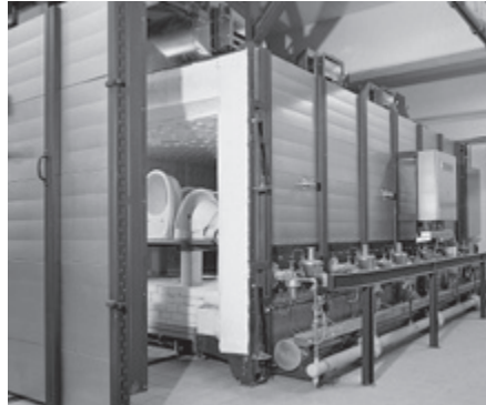
Keramiköfen mit Tem- peraturregelung über Taktsteuerung
